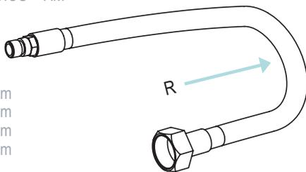
LASCIARE UN TRATTO RETTILINEO PRIMA DELLA CURVATURA A= 2 VOLTE IL DIAMETRO ESTERNO DEL FLESSIBILE.
