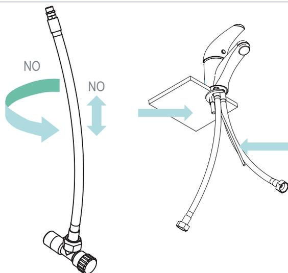
LASCIARE UN TRATTO RETTILINEO PRIMA DELLA CURVATURA A=2 VOLTE IL DIAMETRO ESTERNO DEL FLESSIBILE.
